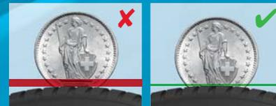
Ob dies der Fall ist, können Sie ganz einfach selber mit einem 2-Fränkler herausfinden. Verschwindet das Podest der Helvetia im Reifen oder steht ohne Zwischenraum darauf, beträgt das Profil 4 mm oder mehr.
